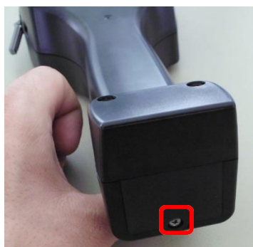
Zdejmowanie pokrywy baterii
